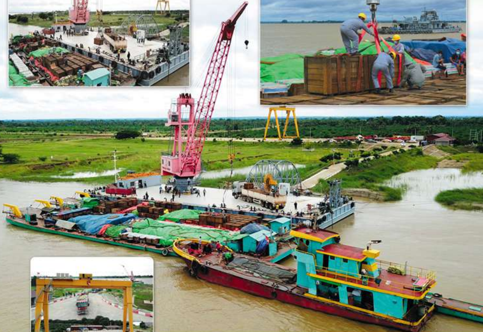
ဆီမီးနံဆိပ်ကမ်းတွင် Domestic 50 Ton Pontoon Crane ဖြင့် ရာသီမရွေး ကုန်တင်၊ ကုန်ချ ပြုလုပ်နေစဉ်
