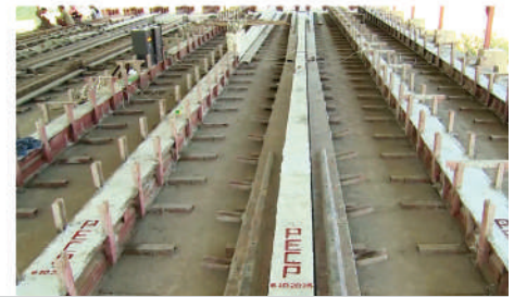
MYANMAR - THAI JV Cement Product Factory ကွန်ကရစ်တိုင် စက်ရုံမှ ကွန်ကရစ်တိုင်များ ထုတ်လုပ်ထားပုံ
