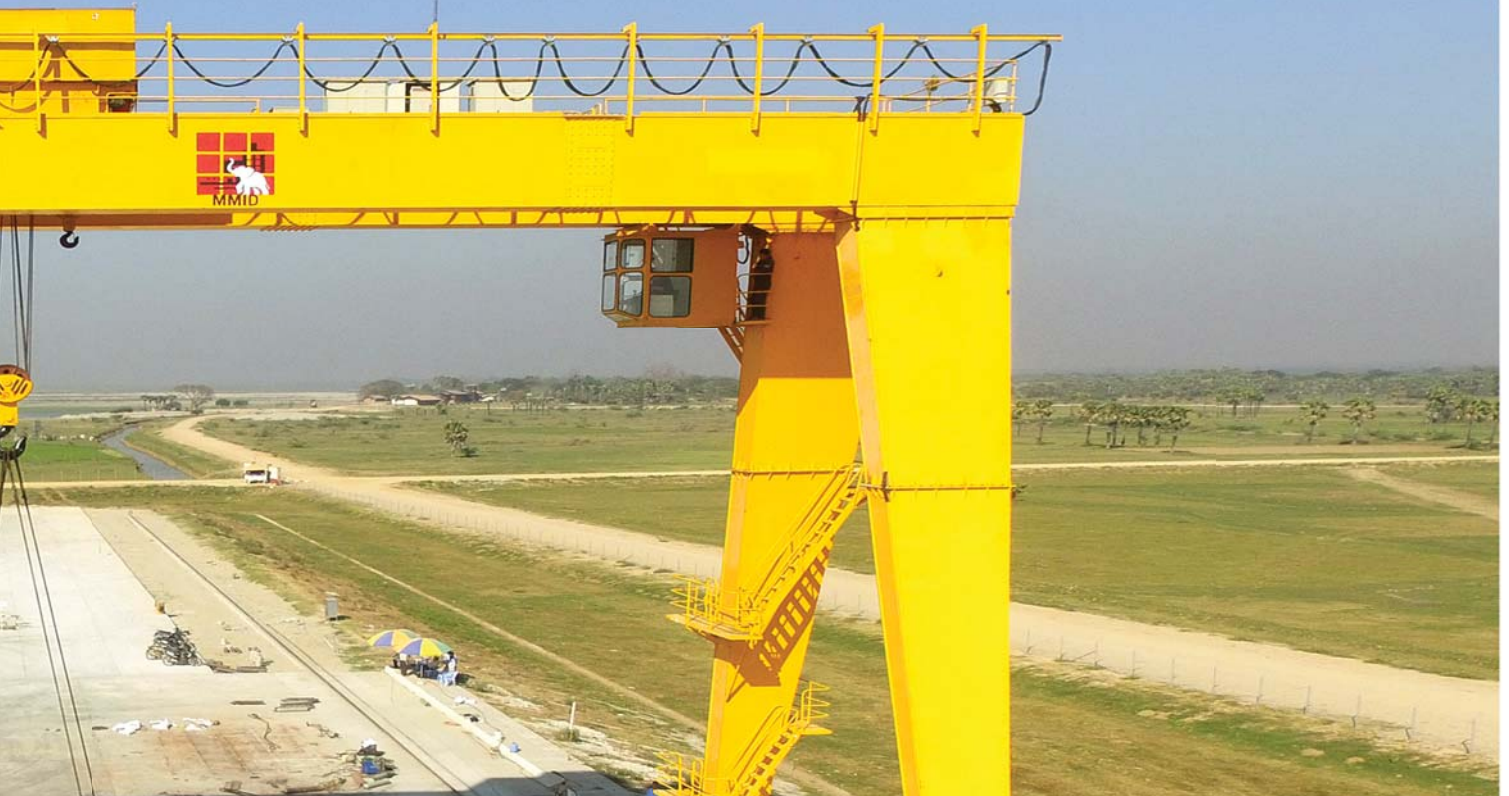
ကုန်တင်/ကုန်ချပြုလုပ်ရန်အတွက် RMG Crane တည်ဆောက်နေပြီး စမ်းသပ်ဆောင်ရွက်နေမှုအား တွေ့မြင်ရပုံ
